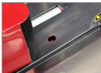
SENSORE PER REGGIATURA AUTOMATICA AUTOMATIC STRAPPING SENSOR
