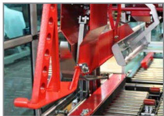
DISPOSITIVO PNEUMATICO CHIUDIFALDE PNEUMATIC FLAP CLOSURE DEVICE
