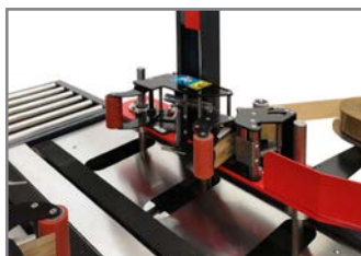
CINGHIE DI TRASCINAMENTO INFERIORI BOTTOM BELTS FEEDING
