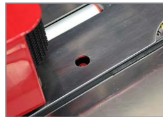
SENSORE PER REGGIATURA AUTOMATICA AUTOMATIC STRAPPING SENSOR
