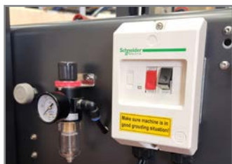
INTERRUTTORE GENERALE MAIN POWER SWITCH
