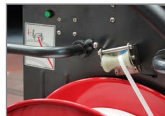
CARICAMENTO AUTOMATICO DELLA REGGIA AUTOMATIC STRAP FEEDING
