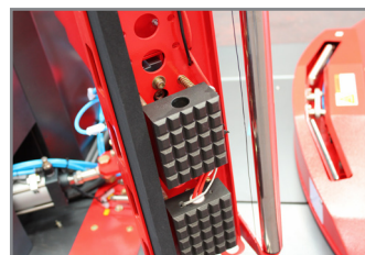
SISTEMA DI AGGANCIO E TAGLIO FILM FILM CUT AND CLAMP SYSTEM
