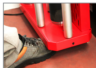
PROTEZIONE PARACADUTE CARRELLO SAFETY STOP DEVICE
