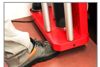
PROTEZIONE PARACADUTE CARRELLO SAFETY STOP DEVICE
