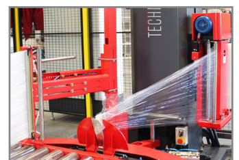
SISTEMA AGGANCIO E TAGLIO DEL FILM FILM CUT AND CLAMP SYSTEM
