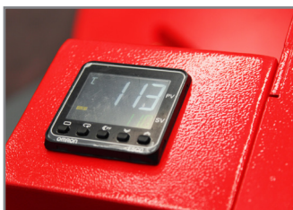
TERMOREGOLATORE SALDATURA FILM SYSTEM CONTROLLED TEMPERATURE
