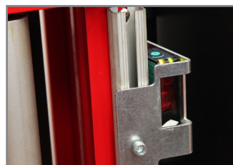
FOTOCELLULA LETTURA PALLET PHOTOCELL TO DETECT PALLET HEIGHT
