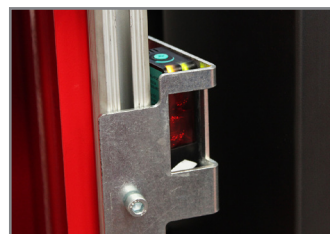
FOTOCELLULA LETTURA PALLET PHOTOCCELL TO DETECT PALLET HEIGHT
