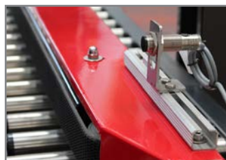
FOTOCELLULA LETTURA SCATOLA FOTOCELLS THAT DETECT BOX
